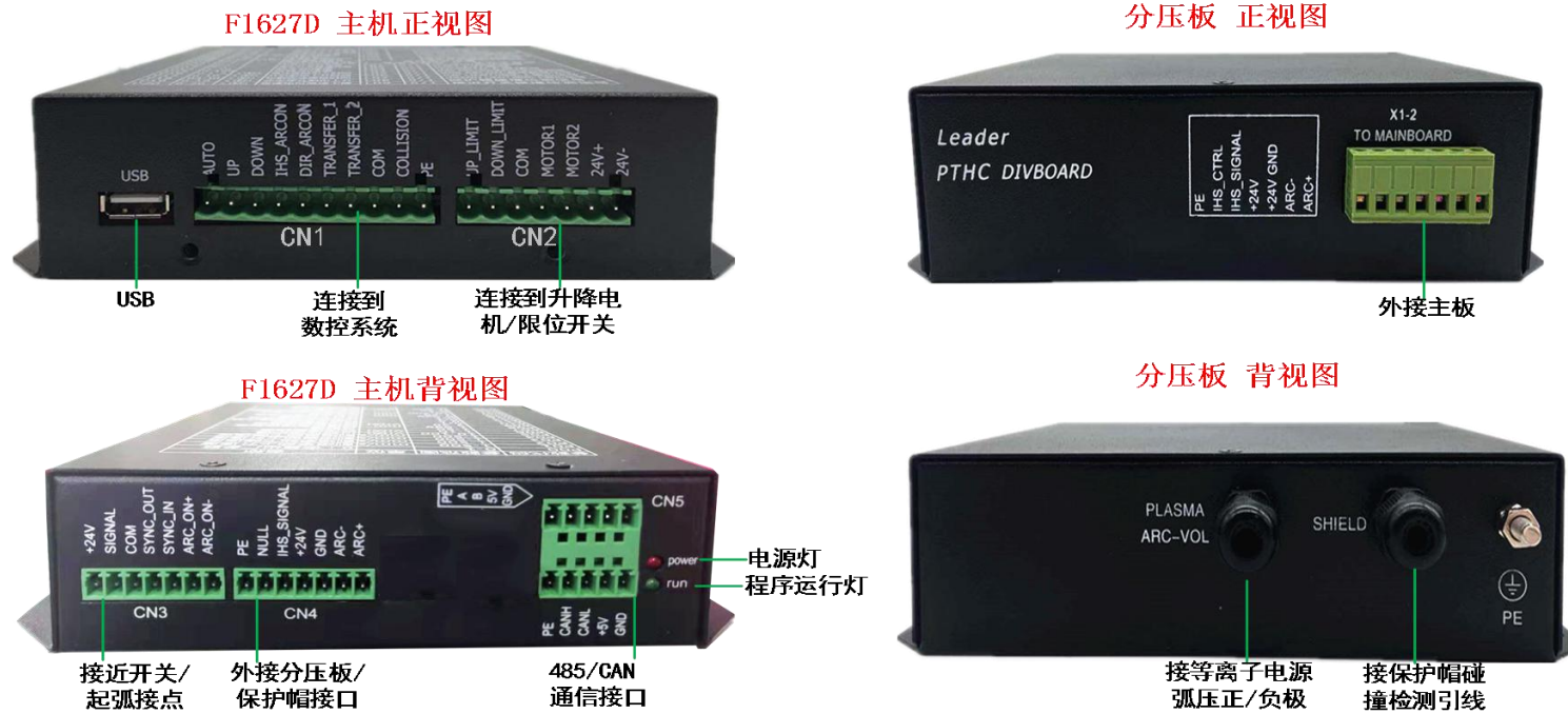
图 3.6 F1627D 机箱及分压板视图
