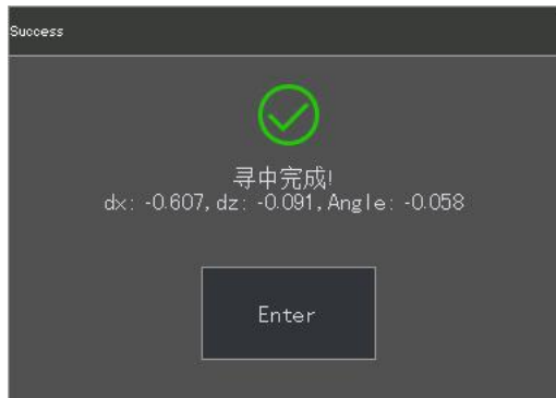
图 3.24 五点寻中矫平完成
